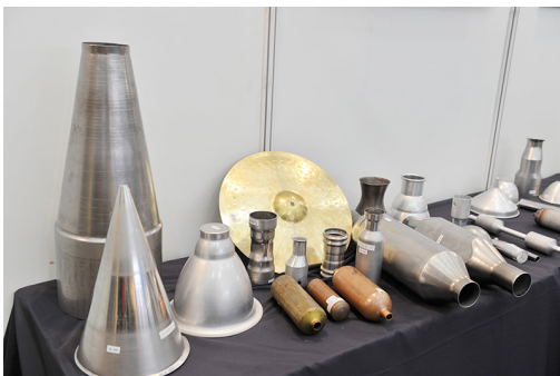
Hình 1. Sản phẩm của phương pháp miết biến mỏng
