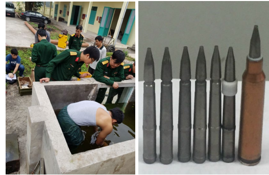
Hình 5. Đạn bắn dưới nước 5,56 x 45mm bắn trên súng bắn hai môi trường.
