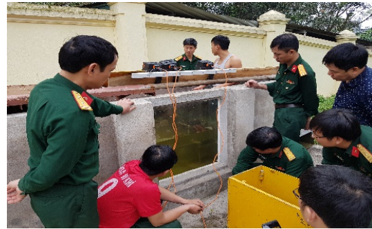
Hình 6. Lắp đặt Crusher đo áp suất khí thuốc và Camera đo tốc độ đạn tại bể thử nghiệm.
