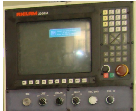
Hình 6. Hệ điều khiển: ANILAM 3300M
